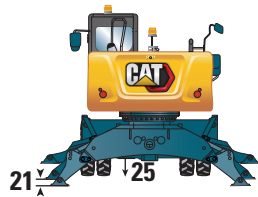
Fahrwerk mit 2 Paar Abstützpratten
